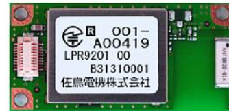
920MHz 帯特定小電力無線モジュール LPR9201 00（標準版 内蔵アンテナ品）
